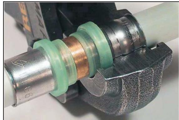
**Применяемый профиль клещей для фитингов SUDO-Press - профиль ТН**
